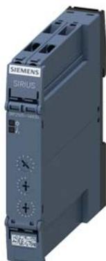
Реле времени, многофункц. 1 переключающий контакт, 13 функций 7 диапазонов времени (0,05 с – 100 ч) 12–240 В AC/DC, AC, 50/60 Гц со светодиодом, винтовой зажим
